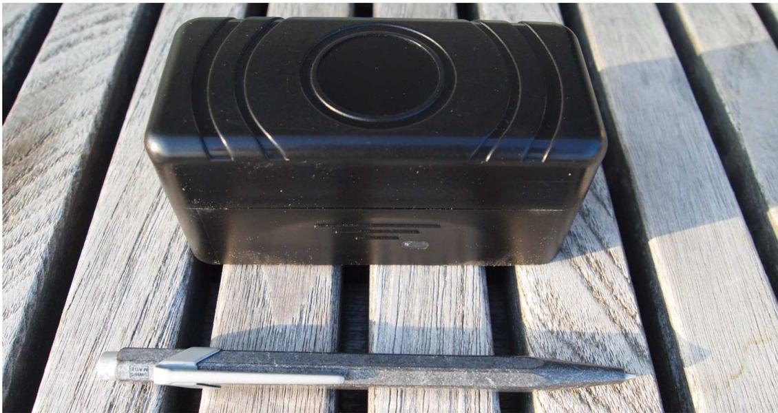
En y cachant la balise de surveillance autonome TT7 qui vous envoie des SMS indiquant sa position GPS dès que celle-ci se réveille en détectant une vibration prolongée ou un mouvement grâce à son capteur « G-sensor » intégré.
